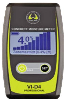
Für die Benutzung bei Feuchtigkeitsmessungen von Untergründen ausgelegt und geeignet für die Vorprüfung der Belegreife von Baustoffen bei CM-Messungen.
