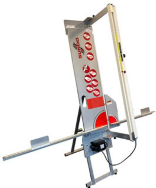
Schneidergerät mit Schienenführung zum präzisen Heißschneiden von Hartschaumplatten mit einer Schnittbreite von 101 cm und einer Schnitttiefe von 30 cm.
